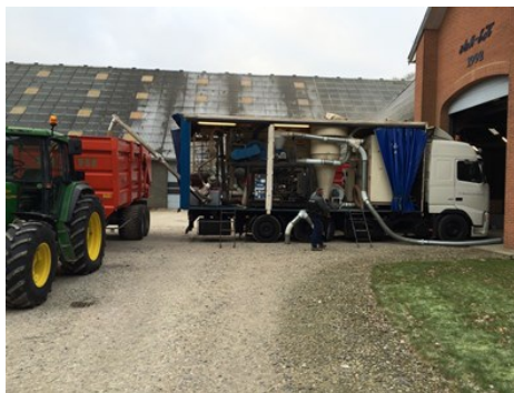
Billede 1 Renseanlæg i arbejde, hvor der læsses direkte på vogn.
