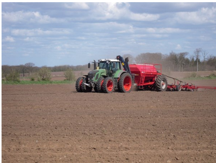
Billede 1 Majssåning. Traktoren er monteret med tvillingmontering på alle hjul med en passende bred afstandsring, så majsens kan sås i mellemrummet (Foto: Thomas Harbo, SAGRO).
