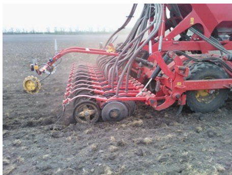
Billede 3 Såmaskiner med individuel trykrulle til dybderegulering for hver skive er velegnede til såning af kløvergræsudlæg – her en Väderstad Spirit. Bemærk, at efterharven IKKE skal anvendes ved såning af græsfrø. (Foto: SAGRO)
