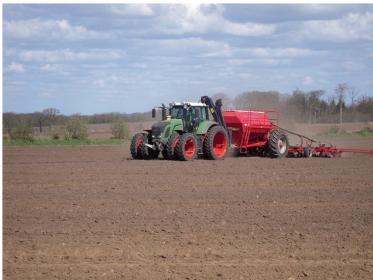
Billede 1 Majssåning. Traktoren er monteret med tvillingmontering på alle hjul med en passende bred afstandsring, så majs kan sås i mellemrummet (Foto: Thomas Harbo, SAGRO)
