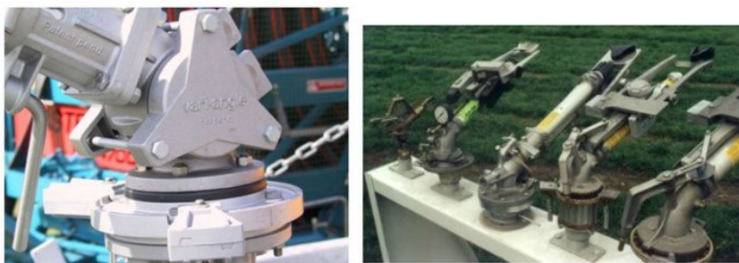
Billede 3 og 4 Vandingskanoner med mulighed for at justere stigningsvinklen
