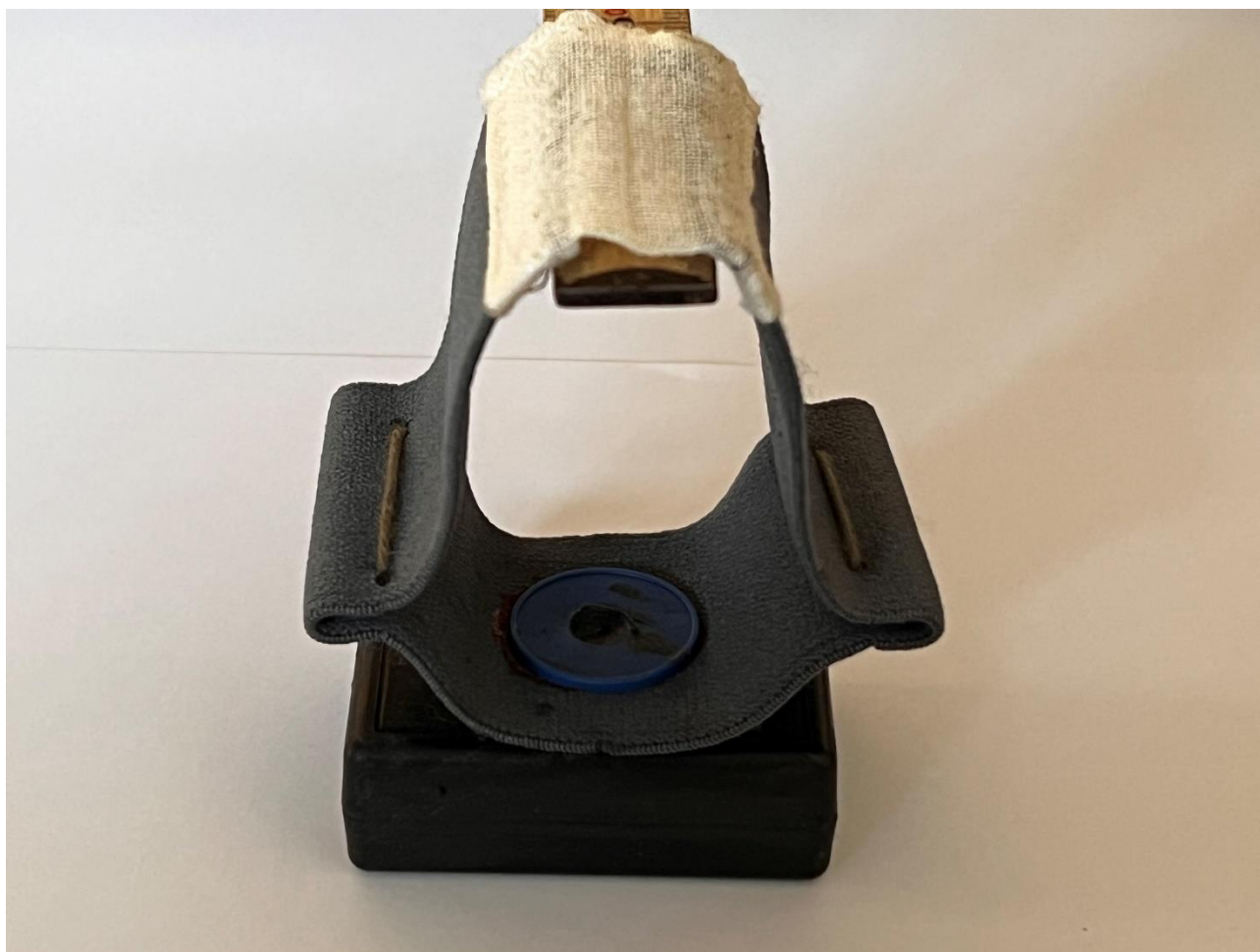
Figur 4: Ekspanderbart GPS-halsbånd med brakeaway-zone anvendt til mærkning af rådyrlam.
