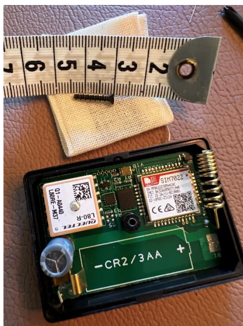
Figur 3: GPS-enheden set uden låg og uden batteri.
