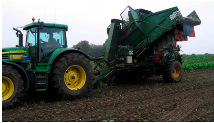
Med en helplanteroptager (Thyregod) kan både rod og top høstes i en arbejdsgang og samensileres med et saftopsugende fodermiddel som majs. Foto: Karsten A. Nielsen, SEGES.
