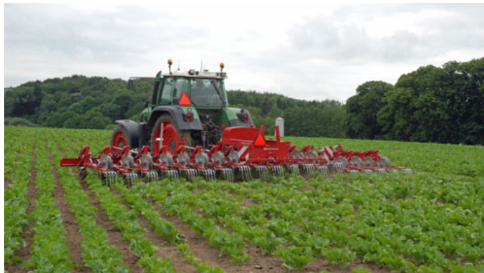
GPS og sektionsvis hævnning af renseaggregaterne betyder, at der effektivt kan renses i kiler. Kamerastyring betyder, at det er muligt at rense tæt på rækken. Foto: Kongskilde.
