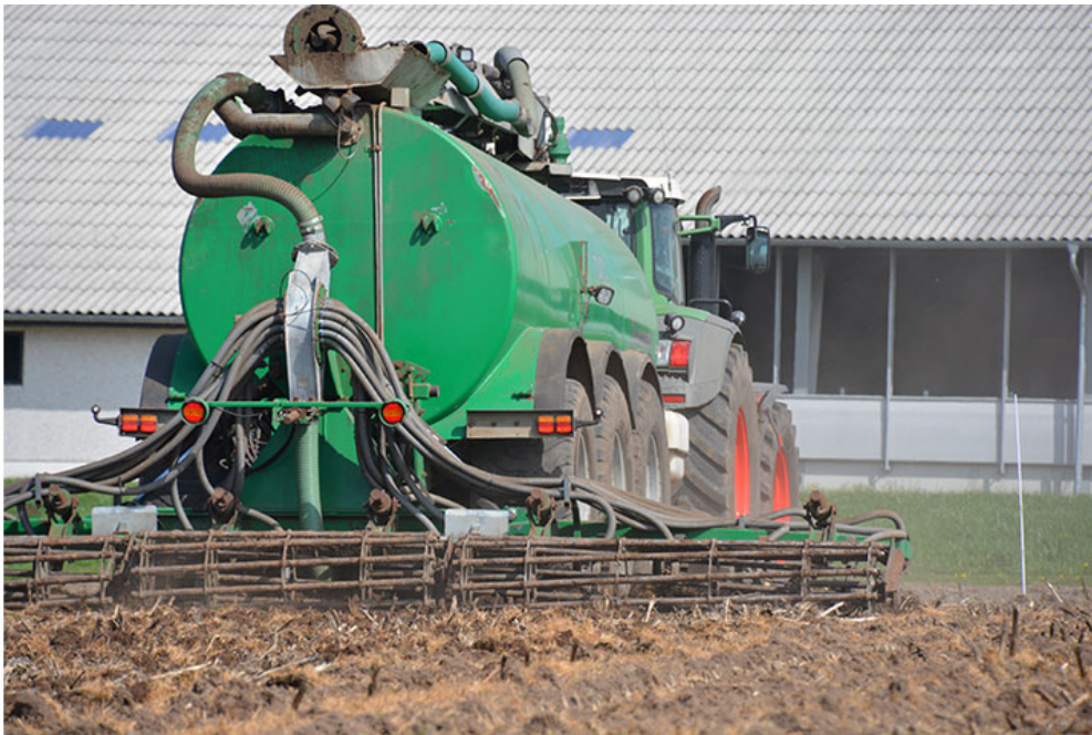
Sortjordsnedfældning er en god løsning, da det giver en placeringseffekt af godningen. På svær lerjord er der dog ikke god erfaring med nedfældning pga. strukturskader. Foto: Torkild Birkmose, SEGES.
